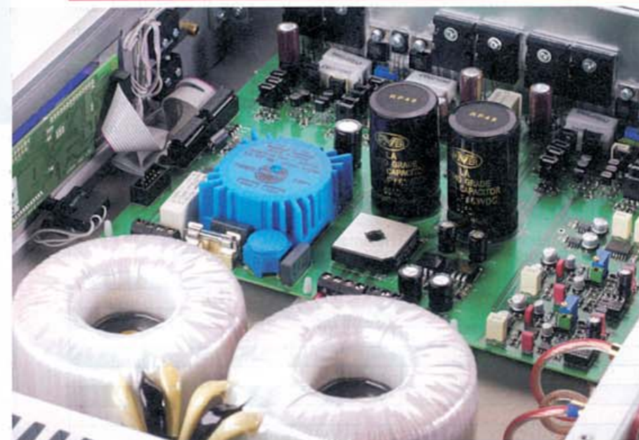
Rosbacher Ordnungssinn: Der Platinen-Trafo ernährt die digitale Bedienelektronik, die vorgeschaltete kleine blaue Drossel unterbindet Rück-Einstreuungen in das Netz und auf die großen Umspanner. Auf der rechten Seite die Phono-Sektion.
