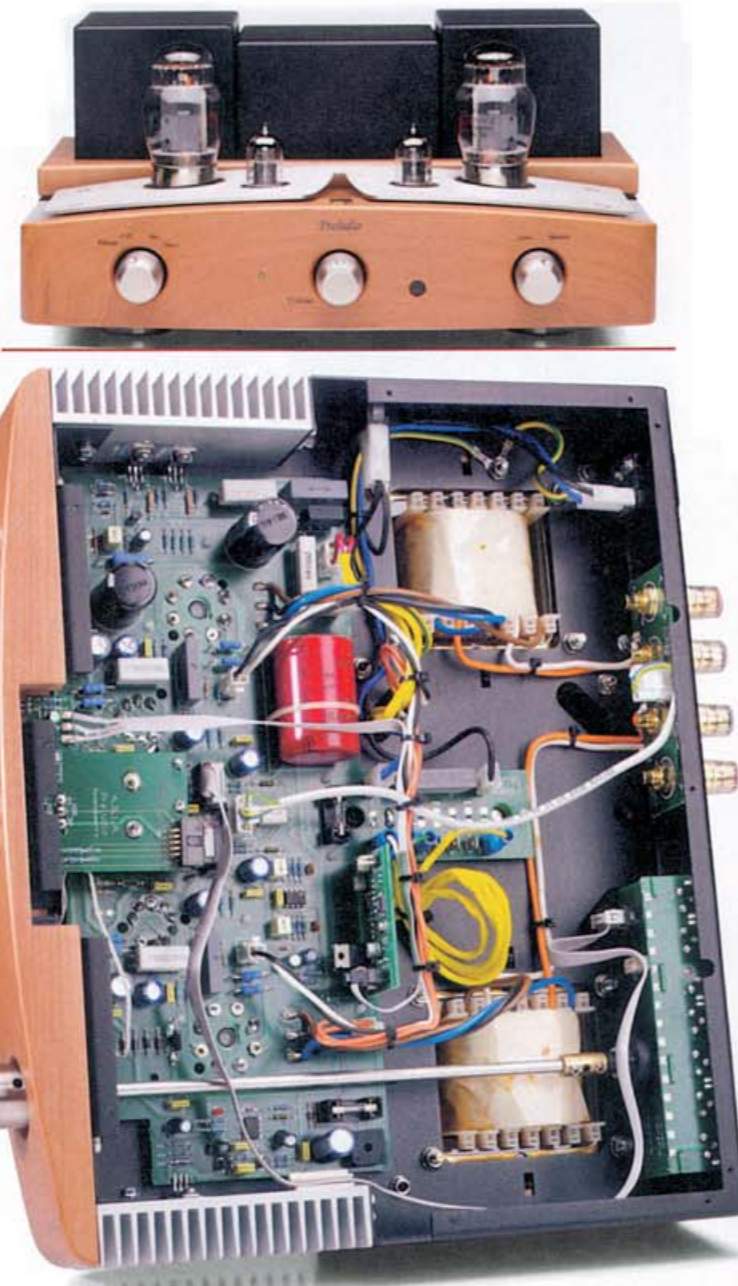
Italienische Feinkost: Die Transistoren am oberen Alu-Kühlkörper helfen, die Endstufen-Hochspannung zu säubern, das IC am unteren Profil hält die Vorstufen-Heiz- und Endröhren-Kathodenspannung konstant.
