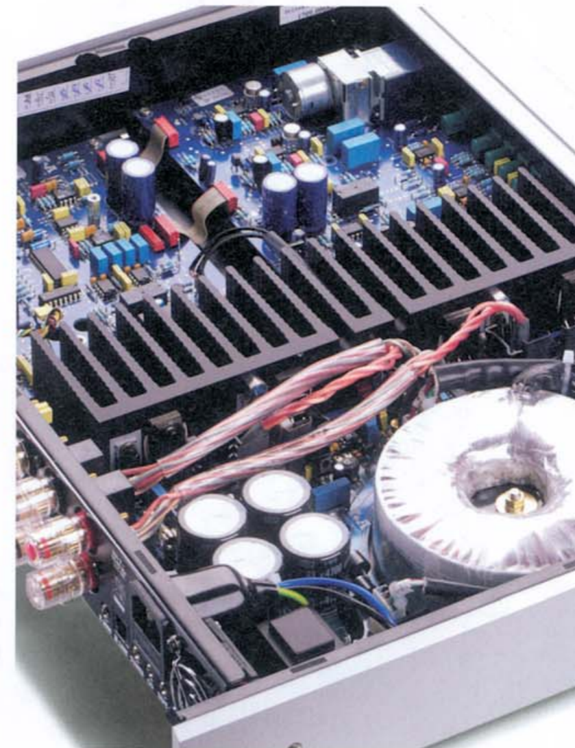
Herforder Reinheitsgebot: Bei den Boxenklemmen, bei Schraubkontakten und bei der Versilberung von Leiterbahnen schwört T+A auf eine Galvanik, die relativ viel Edelmetall direkt ohne verzerrende ferromagnetische Zwischenschichten aufs Kupfer aufbringt.
